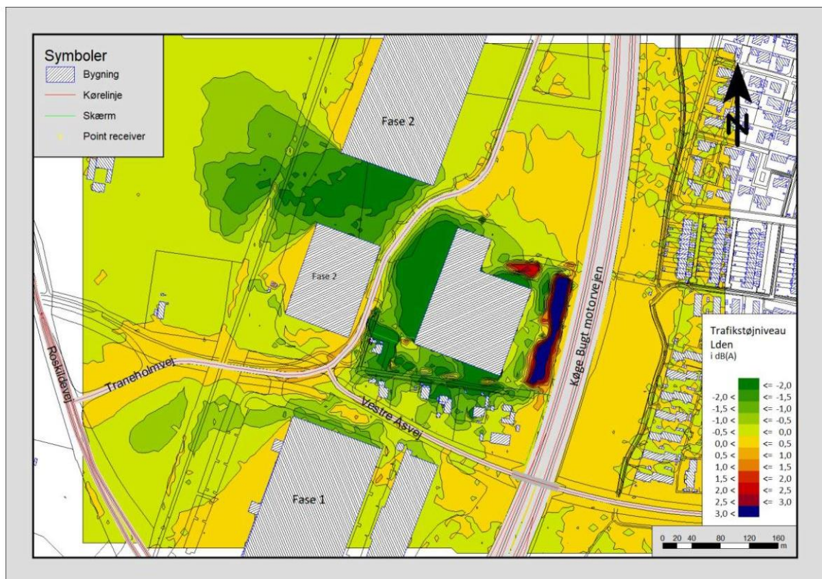
Figur 7.7 Beregnede ændringer af trafikstøj ved etablering af projekt Mars. Grønne farver viser, at støjniveauet bliver lavere særligt syd og vest for den planlagte bygning samt foran den østlige bygningsfacade
